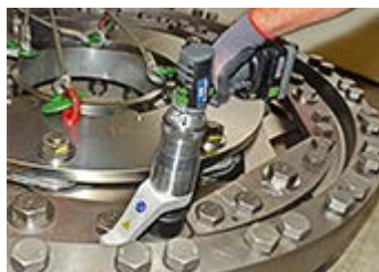
大型フランジボルト締め
