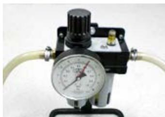
付属の精密エアレギュレーターでトルク設定を行います。
