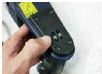
トルク設定99段階。トルク換算表を参考にメモリをセット。
