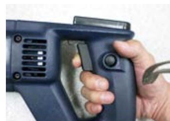
トリガーを引いて使用開始。締め・緩め方向切替ワンタッチ。
