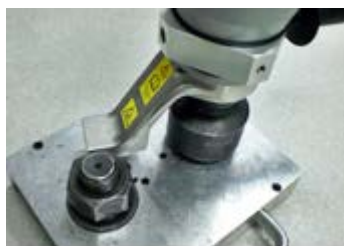
ソケット装着後、反力受けがしっかりと受けられるか事前確認
