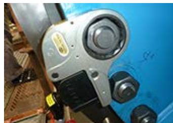
隣のボルトで反力を受けます。 本体底部＝反力受け
