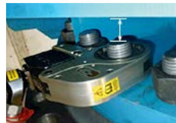
高さ制限のある狭いボルト締め で薄いVSレンチが活躍。
