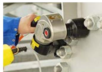
大型フランジボルト締め・緩め作業。高精度トルク管理。
