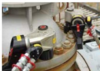
油圧レンチ2台で複数ボルトを同時並行締め
